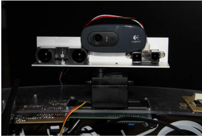
Abbildung 2: Drehbare Abstandssensoren und Kamera
